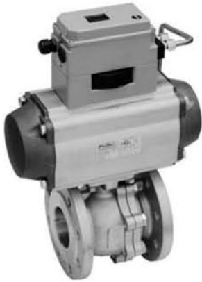
图8 • 3730-4型数字式电气阀门定位器用于PROFIBUS-PA 装配在符合VDI/VDE 3845的角行程执行机构上
