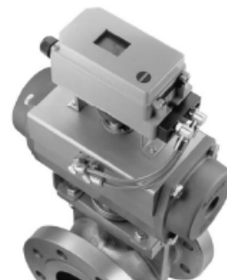
图3 · 3730型，按VDI/VDE 3845标准 装配到角行程气动执行机构
